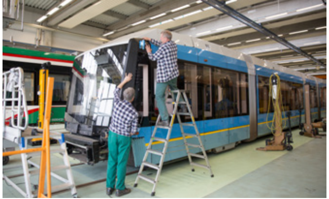
Zwei Mitarbeiter der CVAG kleben die A-Säulenverkleidung an eine Variobahn.
