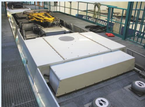
**Neue Verdichter sollen für prima Klima sorgen – Pro Klimaanlage werden zwei Verdichter ersetzt. Pro Fahrzeug gibt es zwei Klimaanlage, welche durch die neuen Bauteile stabiler im Betrieb werden sollen.**
